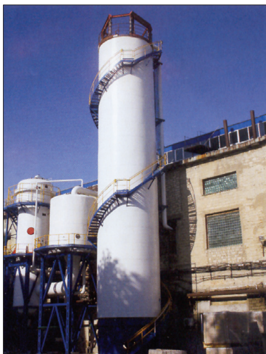
شکل ۷: مایشه عمودی پخت ۳ بعد از نصب در تابستان ۲۰۱۰ (طرف چپ، دستگاه تبخیر ریزشی)
