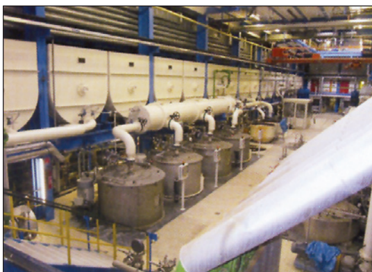
شکل ۱۵: سانتریفوژ پخت ۳ - افنا مدل BWS SC 1350
